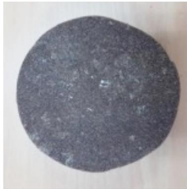
Gambar 8. Sampel pengujian komposit serbuk gergaji
