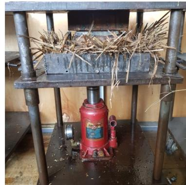
Gambar 7. Prosedur penekanan untuk pencetakan panel komposit
