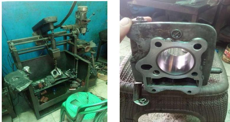
Gambar 7. Proses Penghalusan Dinding Silinder Dengan Mesin *Honing*
