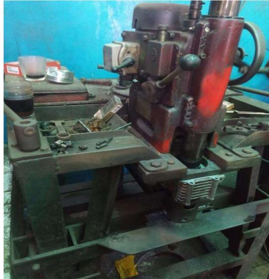
Gambar 4. Pemasangan Blok Silinder
