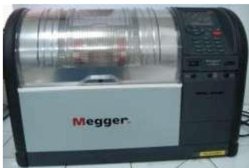
Gbr 3. Alat Penguji Tegangan Tembus Megger OTS 100AF
