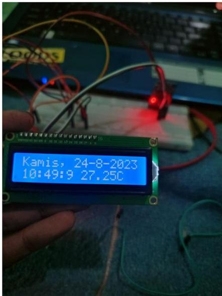
Gambar 6 : Pengujian RTC
