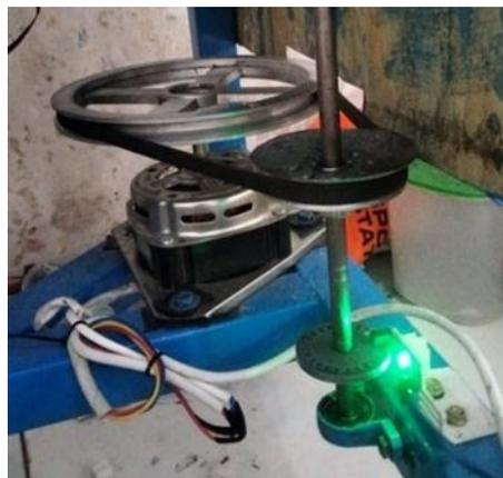
Gambar 5. Pengujian Sensor Kecepatan
