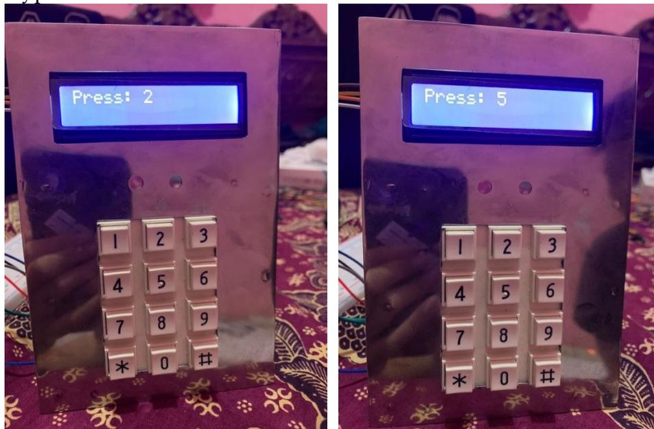
Gambar 7: Pengujian Pengujian *Keypad* 3×4 dan LCD I2C 16×2 Press 2 dan 5
