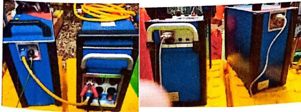
Gambar 4. 7 Rangkaian Alat Ukur CPC 100 dan CP-TD
