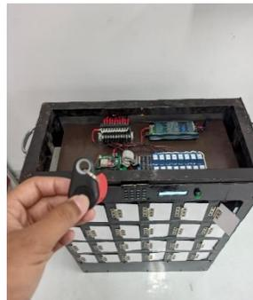
Dalam pengujian ini data yang diambil adalah dalam besaran *seconds* atau detik pada setiap jarak yang telah ditentukan dan dilakukan dengan cara memberikan sinyal BLE Tag pada jarak dan sudut tertentu.
