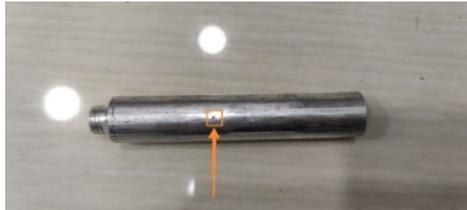
Gambar 6. Kebocoran halus
