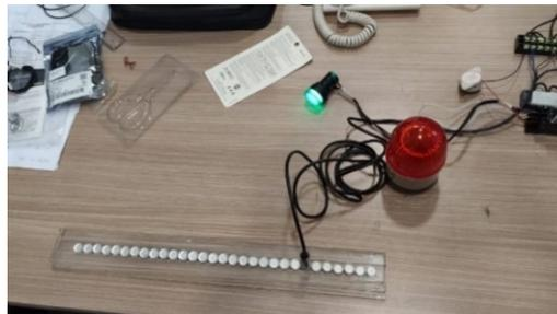
Gambar 17. Sistem deteksi *aluminium slugs* (*idle*)
