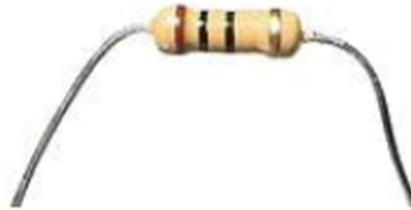
**Gambar 2. 2** Bentuk Fisik Resistor
