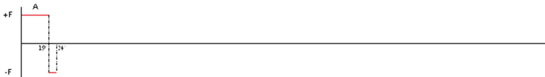
Gambar 6. Gaya tarik yang muncul sebesar -F akibat interaksi magnet 1 dengan celah magnet A dan magnet B
