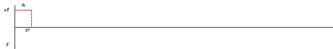
Gambar 5. Gaya dorong yang muncul sebesar +F , akibat interaksi magnet 1 dengan magnet A
