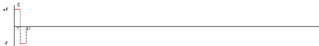
Gambar 16. Gaya tarik yang muncul sebesar -F akibat interaksi magnet 3 dengan celah magnet C dan magnet D
