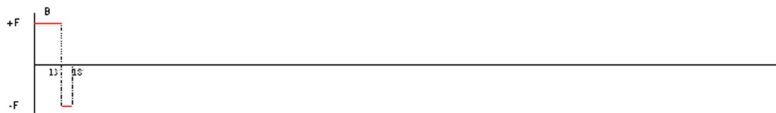
Gambar 11. Gaya tarik yang muncul sebesar -F akibat interaksi magnet 2 dengan celah magnet B dan magnet C
