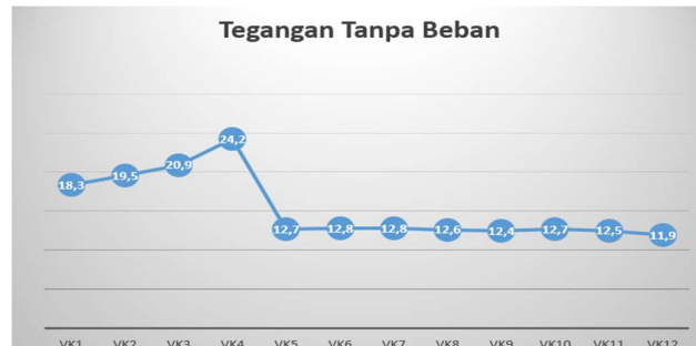
Gambar 2. gambar grafik tegangan generator magnet permanen tipe axial tanpa beban
